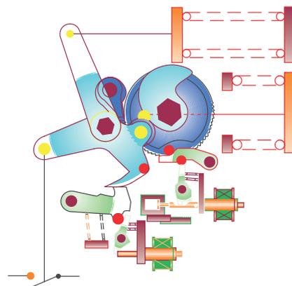
**Рис. 5: Выключатель отключен**
