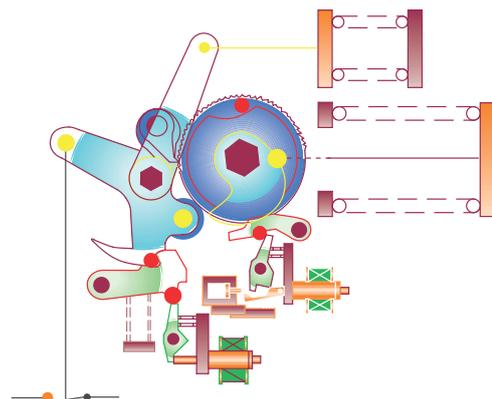
**Рис. 6: Выключатель включен**
