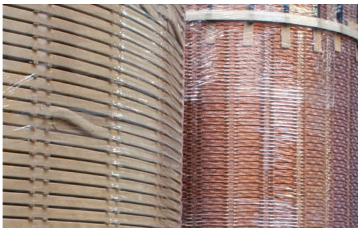
Готовые обмотки ожидают последующего монтажа
