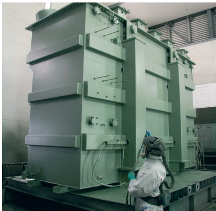
Перед транспортировкой поверхность баков обрабатывается воздушной струей.
