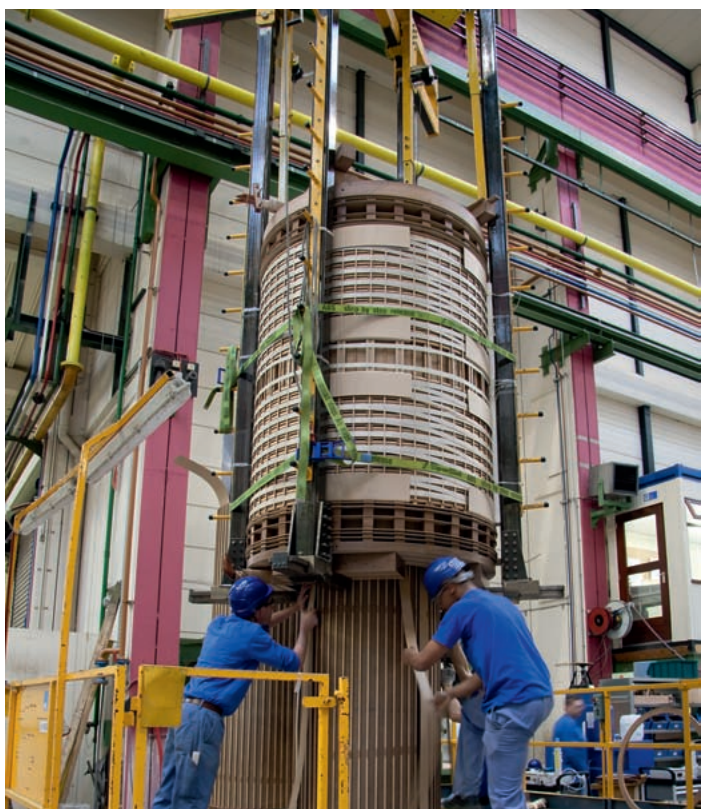
Сборка катушки тягового трансформатора 60 МВА 230/27,5/27,5 кВ
