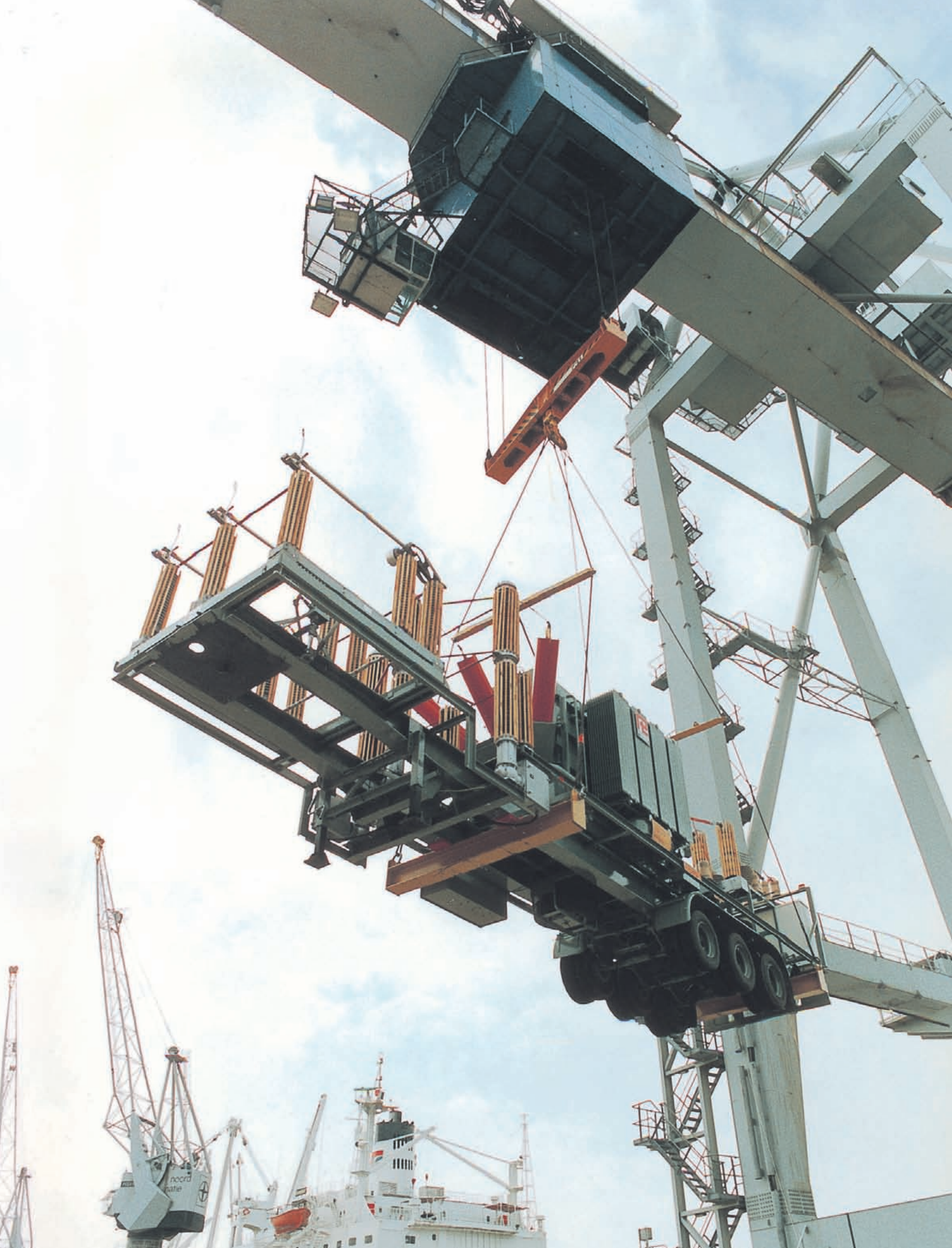
Транспортировка полностью укомплектованной мобильной подстанции
