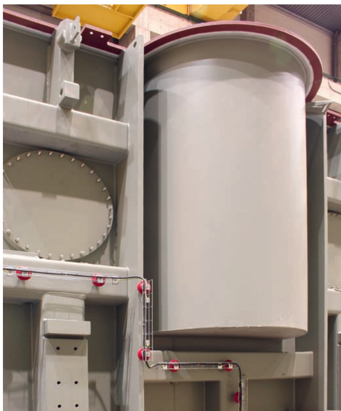
Бак тягового трансформатора 60 МВА 230 кВ
