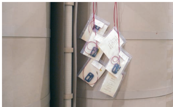
Оптоволоконные датчики измеряют фактическую температуру в наиболее нагретых точках
