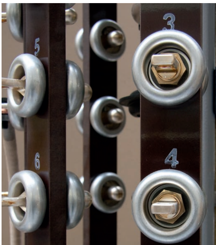
Деталь РПН, установленного внутри масляного бака
