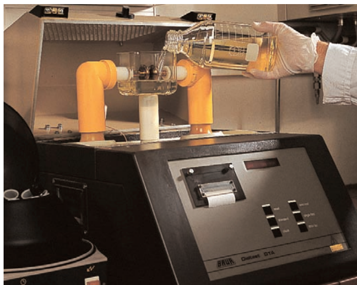
Проверка качества масла в химической лаборатории
