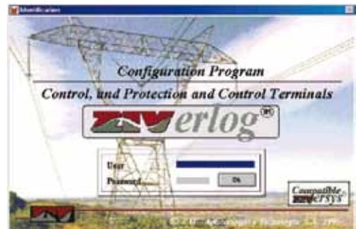
ZIVERLOG позволяет легко сконфигурировать приложения управления терминала ячейки. Конфигурация создается в автономном режиме и загружается в терминал при помощи специального программного обеспечения в виде файла.
