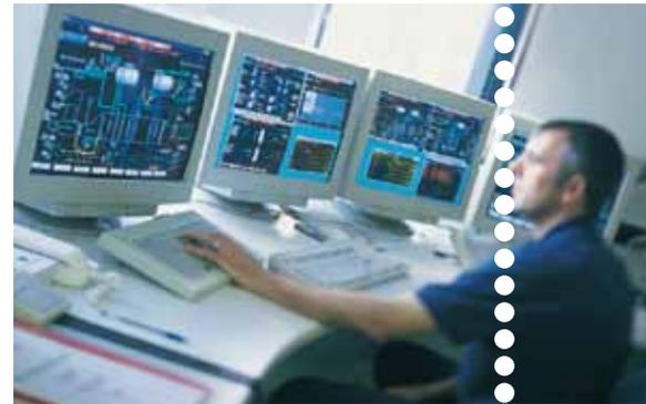
Рабочий пульт системы состоит из промышленного ПК, цветного монитора, алфавитно-цифровой клавиатуры и мыши. Пульт обеспечивает реализацию следующих функций:
